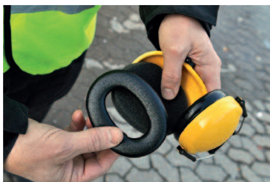
Tætningsringe og indlæg til ørekopper kan rengøres/udskiftes
