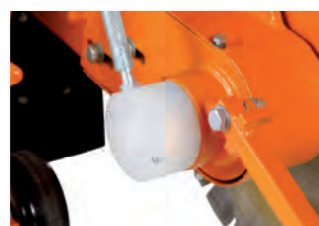
Wasserzuführung durch die Schneidwelle
