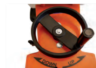
Absenkung über Handrad
