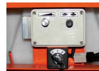
Elektrostart + Steuerpult für Vorschubgetriebe
