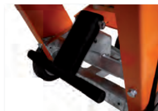
Absenkung über Fusspedal
