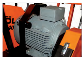
Motor abnehmbar über Schnelltrennsystem
