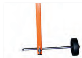
Kontrollierter Schnittverlauf durch Richtungsanzeiger
