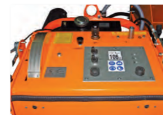
Übersichtliches Bedienpult mit Schnitttiefeanzeige
