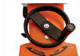
Absenkung über Handrad
